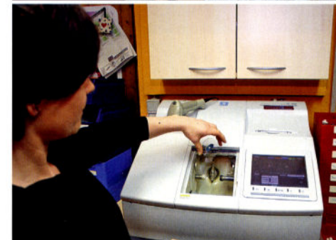
Modernste Ausstattung Zum Schleifen der Gläser bedient Sabine Milchraum topmoderne Apparaturen.
